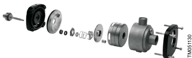
Hydraulique des pompes CME et CM
