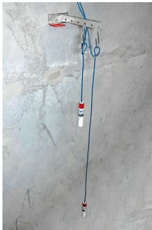
Montage type, suspendu par le câble sur support de sonde
