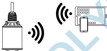
Figure 3.3 Connexion sans fil aux unités de réglage standard avec Bluetooth intégré LE
