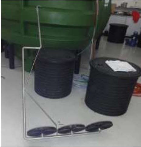
Les diffuseurs d'air avec tuyau en acier inox (VODALYS 14 EH)
