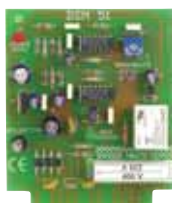
DSN 51 mono-électrode à temporisation variable automatique
