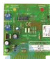
DSN 52 bi-électrode avec détection niveau critique
