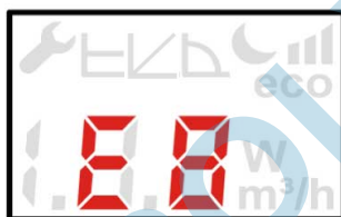
Ill. 16: Affichage du code d'erreur E8 (défaut moteur)
