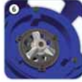
Système dilacérateur Système dilacérateur formé d'un couteau rotatif et d'un disque percé avec bords aiguisés pour découper finement les corps filamenteux et empêcher ainsi la roue de se bloquer. Plus de 69 000 coupes par minute !
