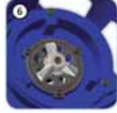
Système dilacérateur Système dilacérateur formé d'un couteau rotatif et d'un disque percé avec bords aiguisés pour découper finement les corps filamenteux et empêcher ainsi la roue de se bloquer. Plus de 69 000 coupes par minute !
