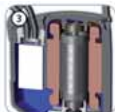
Moteur et accessoires électriques Moteur à sec avec protections thermiques. Modèles monophasés avec condensateur interne, boîtier de commande muni d'un condensateur avec disjoncteur et protection ampérométrique. Modèles triphasés équipés de relais de protection moteur.
