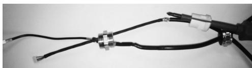
3. Poussez avec précaution le câble d'antenne dans le tube en caoutchouc depuis le côté et retirez l'outil (par exemple le tournevis).
