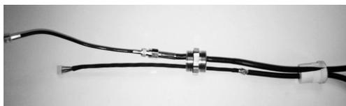
4. Vérifiez que les deux câbles sont insérés correctement dans le tube en caoutchouc.
