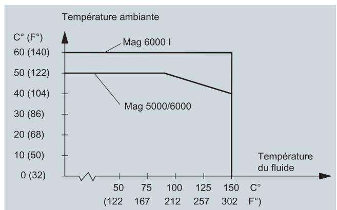
Température ambiante max. en fonction de la température du fluide
