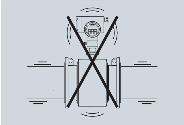
Le capteur doit toujours être complètement rempli de liquide.
