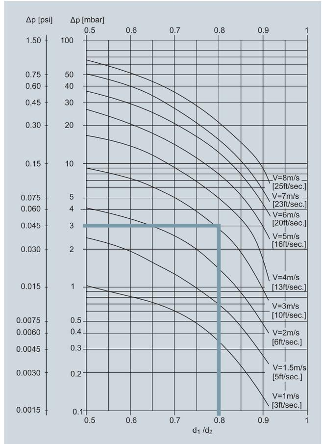
Perte de charge en fonction de la réduction du diamètre nominal entre deux raccords réducteurs
