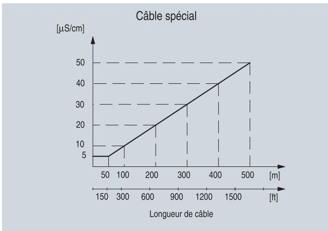
Conductivité minimale du fluide (avec câble d'électrode spécial)
