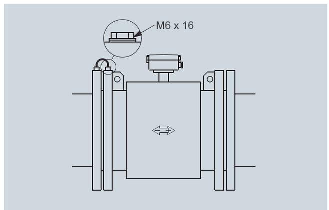
MAG 1100, MAG 3100 (sur PTFE et PFA) : sans électrodes de terre dans des tubes conducteurs (utiliser joint en graphite pour MAG 1100)
