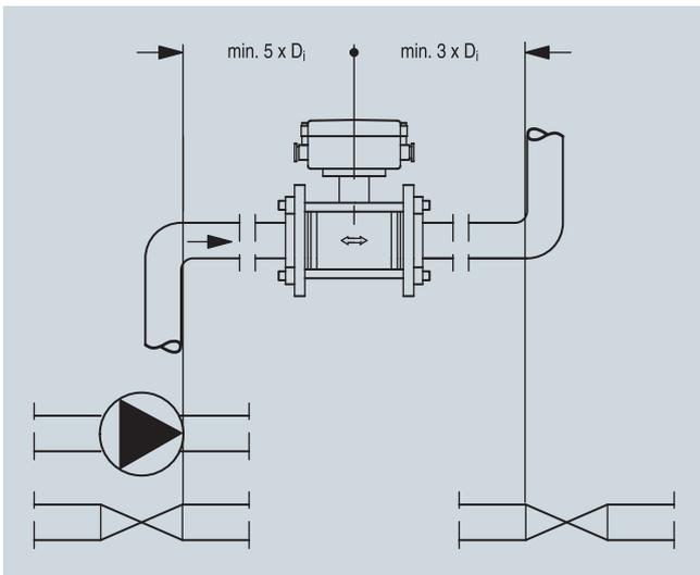
Installation entre conduites en U, pompes et vannes : Tronçons amont et aval standard
