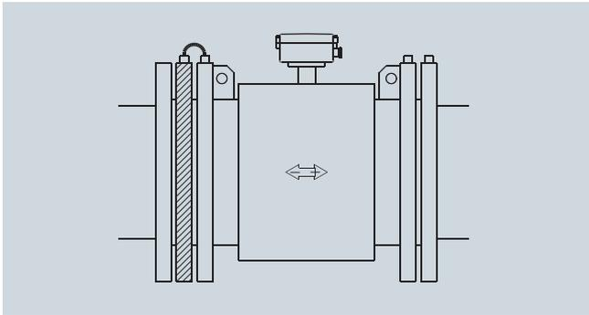
Avec électrodes de terre dans des tubes non conducteurs (utiliser joint en graphite pour MAG 1100)
