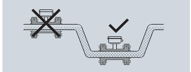
Installation dans conduite en U sur système d'écoulement partiellement rempli
