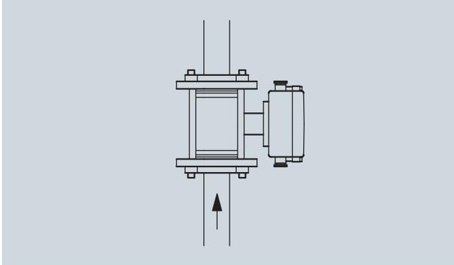
Installation sur conduites verticales à sens d'écoulement montant pour la mesure de fluides abrasifs
