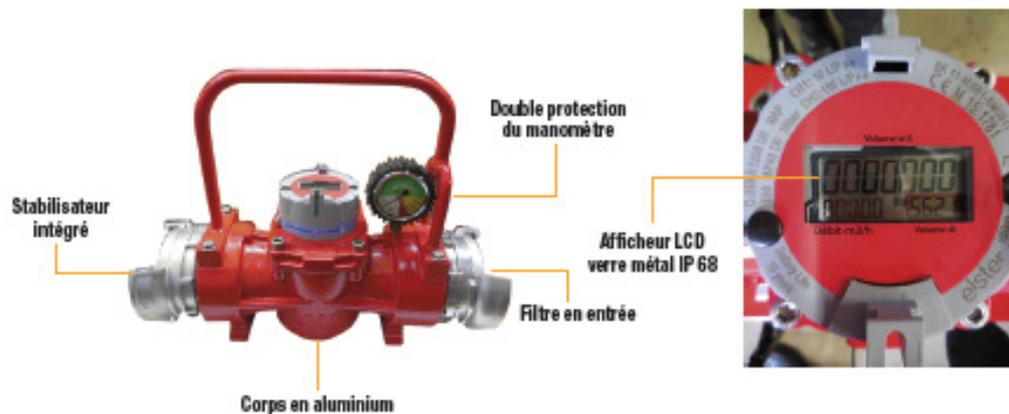
Ce nouveau contrôleur de débit/pression pour poteau et bouche d'incendie utilise une nouvelle technologie inductive sans accouplement mécanique pour maximiser la dynamique de mesure, le maintien et la longévité du contrôleur.
