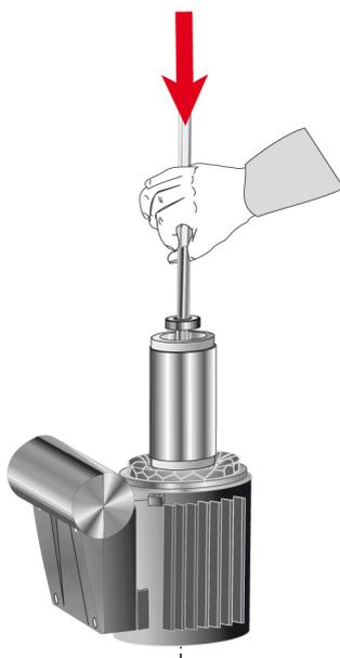
11. Mettre en place la partie tournante de la garniture mécanique 433.
